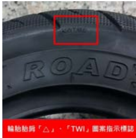
圖 5.3-10 機車輪胎磨耗指示點圖
