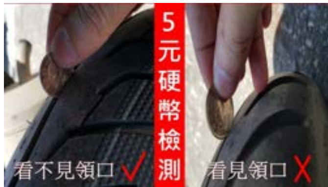
圖 5.3-10 機車輪胎磨耗指示點圖
