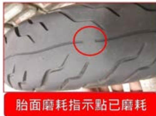
圖 5.3-11 機車輪胎磨耗檢視方法圖
